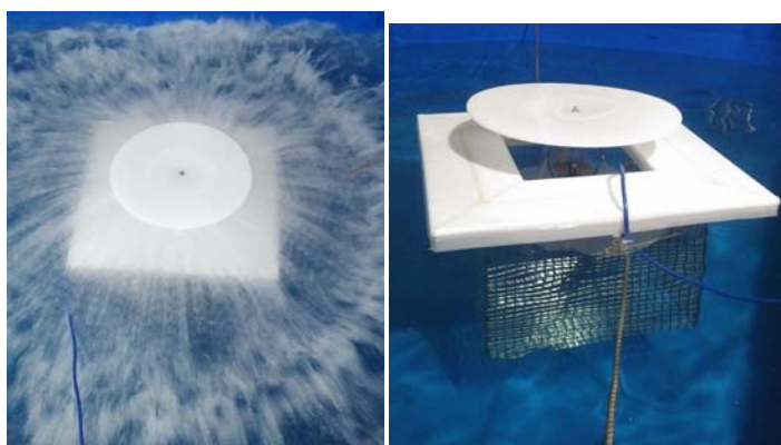
Фото 2. Аэратор Поток-Фонтан с защитной сеткой в работающем (слева) и в отключенном положении.
